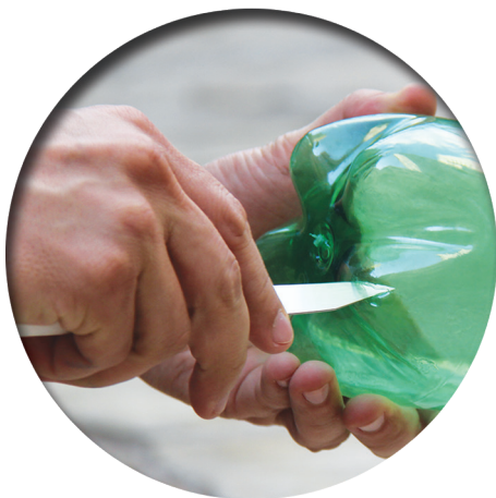
Figura 2: Com uma faca, faça furos na parte inferior da garrafa, para o escoamento da água.
