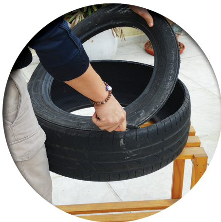
Figura 2: Com o auxílio de uma faca, corte a parte lateral do pneu.
